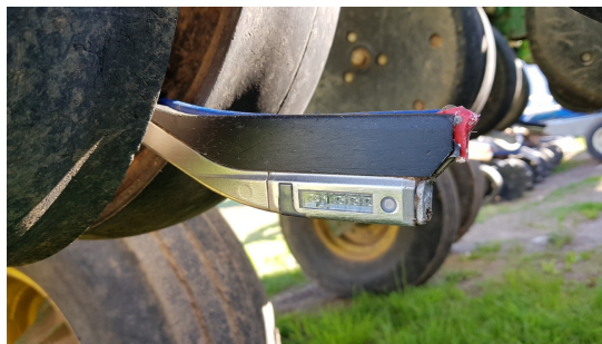
Smart Firmer de Precision Planting Temp, TEE, M.O., Résidus
