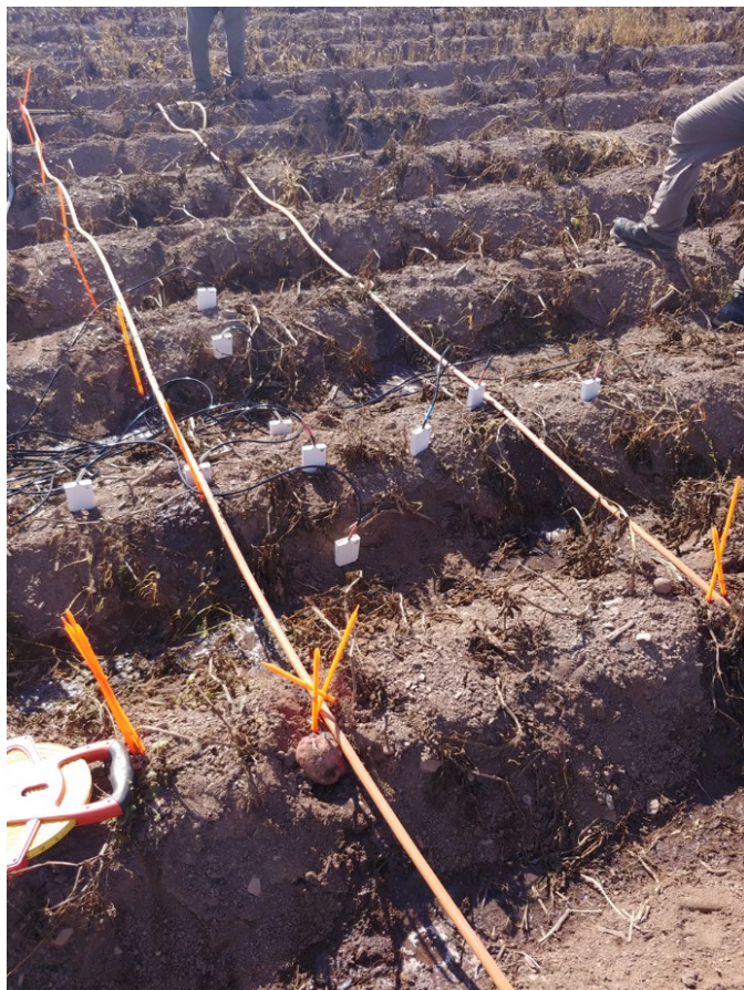
Figure 9. Disposition des 10 sondes TDR dans le système cultural en configuration « perpendiculaire aux billons ».
