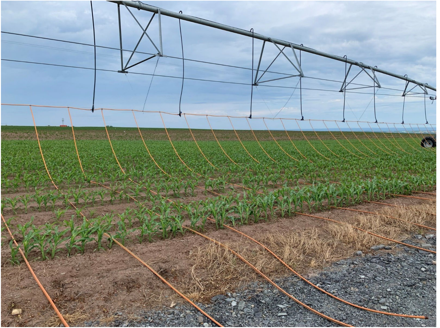
Figure 15. Vue de près du goutte-à-goutte fixé sur les pendillards flexibles.
