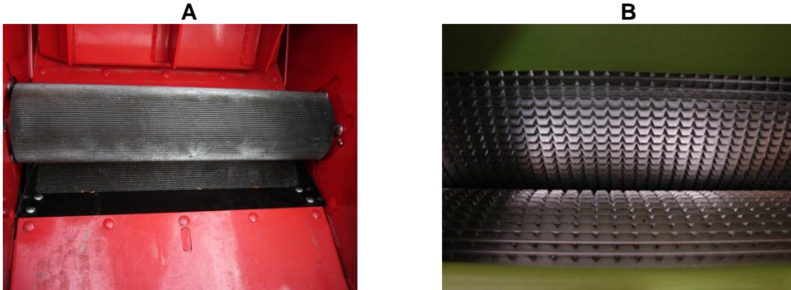
Figure 4. Rouleaux craqueurs conventionnels (A) et rouleaux de la technologie Shredlage mc (B). Sources A : Dion-AG Inc., B : Shredlage LLC.
